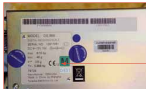
CE-merket vekt med ID-nummer fra et teknisk kontrollorgan.
