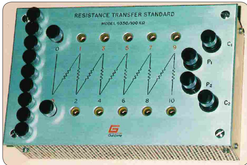
Hamon stegenormal med 10 resistorer koblet i serie. Ved hjelp av kortslutningskontakter kan man lage en parallellkobling med 1:100 av motstandsverdien
